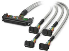
Cable redondo confeccionado; control: Siemens S7-300 (6ES7 322-1BP00-0AA0 y 6ES7 322-1BP50-0AA0 (conexión a negativo)); conexión 1: Conector enchufable Fujitsu (1x 40-polos); conexión 2: Hembra de conexión IDC/FLK (4x 14-polos); longitud de cable: 8 m
