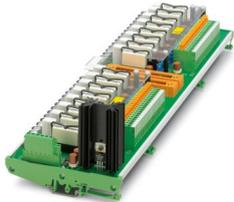
Módulo de relés de salida de 16 canales con conexión por tornillo y conexión de sistema de 50 polos, el lado de excitación está asegurado y sujeto al potencial de forma opcional, para tarjeta Yokogawa SDV 541, anchura de módulo: 425 mm
