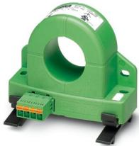
Convertidor de corriente universal para la medición de corrientes continuas, alternas y distorsionadas, corriente de entrada 0 ... 200 A, salida 4 ... 20 mA
