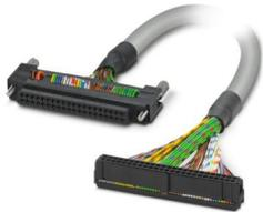
Cable redondo confeccionado; control: OMRON CJ1 (OD 231, OD 261) CS1, C200H (OD 218, OD 219); conexión 1: Conector enchufable Fujitsu (1x 40-polos); conexión 2: Hembra de conexión IDC/FLK (1x 50-polos); longitud de cable: 2 m
