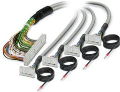
Cable redondo confeccionado apantallado; conexión 1: Hembra de conexión IDC/FLK (1x 50-polos); conexión 2: Hembra de conexión IDC/FLK (4x 14-polos) (La pantalla trenzada se ha conducido a cuatro extremos de cable separados.); longitud de cable: 2 m
