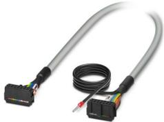
Cable redondo confeccionado apantallado; conexión 1: Hembra de conexión IDC/FLK (1x 14-polos); conexión 2: Hembra de conexión IDC/FLK (1x 14-polos) (La pantalla trenzada sobresale por el extremo de cable separado.); longitud de cable: 1,2 m
