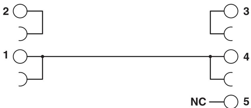
Esquema de conexiones PLC-VT
