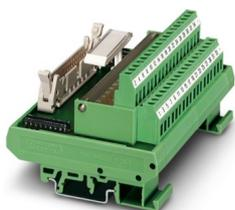
Módulo VARIOFACE, con conexión por tornillo y conector enchufable de cable plano, para el montaje sobre NS 32 o NS 35/7,5, con conector macho, así como gatillos de bloqueo cortos y largos para conectores hembra, número de polos 40, con indicación luminosa
