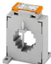
Transformador corriente de barra pasante, corriente primaria 800 A CA; corriente secundaria 5 A CA; clase de precisión 1; potencia de dimensionamiento 10 VA
