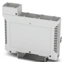
Caja para carril DIN, Parte inferior de la carcasa con pasador de metal, para conectores de bus 10/10, anchura: 39,7 mm, altura: 180,1 mm, profundidad: 137,7 mm, color: gris claro (similar RAL 7035), puentado transversal: Conector de bus para carril DIN (opcional), número de polos conector transversal: 10
