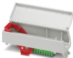
Soporte de técnica de conexión, montado completamente con 1 FKCN de 10 polos, tapa y palanca de desbloqueo; incl. tapa ciega insertable; carcasa de base adecuada: MSTBA 2,5/10-G (1757543)
