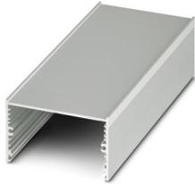
Cajas de perfil extruido, Montaje atornillado, Cobertor de perfil, anchura: 75,6 mm, anchura de perfil (interior): 71,5 mm, anchura de perfil (exterior): 75,6 mm, longitud: 200 mm, profundidad: 43,1 mm
