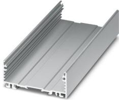
Cajas de perfil extruido, Montaje atornillado, Perfil básico, anchura de perfil (interior): 72 mm, anchura de perfil (exterior): 75 mm, longitud: 200 mm, profundidad: 29,4 mm
