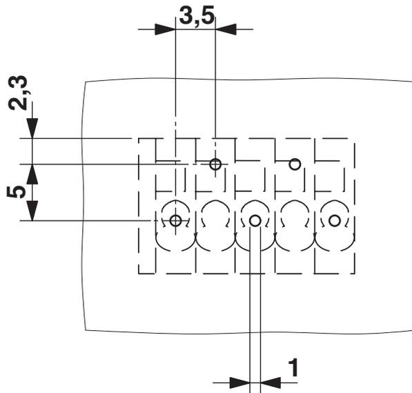
La figura muestra el esquema de taladros de la variante de 5 polos del artículo - la disposición de los pines en zig-zag empieza en el polo derecho. Disposición diferente de los pines a petición.
