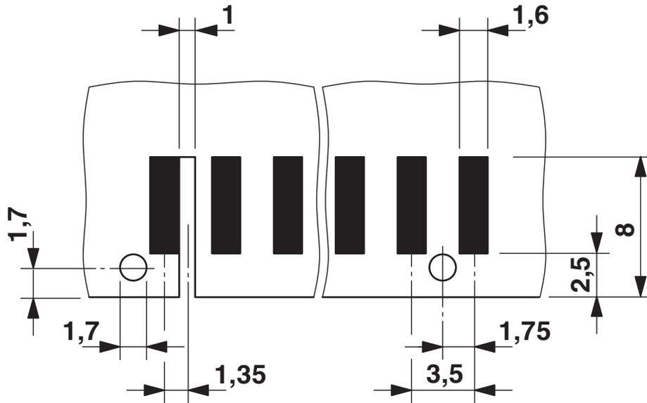
Espesor de placa de circuito impreso: 1,6 ± 0,2 mm
