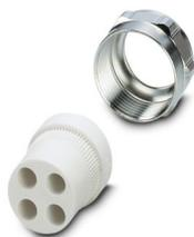
Prensaestopas múltiple Pg21, metálico, compuesto de goma obturadora con varios taladros (4 de 6,5 mm) y un tornillo de apriete, para tubuladuras para prensaestopas VC-M-KV-PG21...
