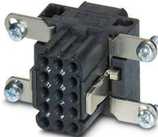
Inserto de contactos, Familia de artículos: VARIOCON, diseño: VC1, material carcasa: PA, número de polos: 15, sección mín. de conductor: 0,14 mm<sup>2</sup>, sección máx. de conductor: 1,5 mm<sup>2</sup>, tensión nominal: 250, corriente asignada: 10 A, Tipo de conexión: Conexión crimpada, Los conectores enchufables deben accionarse solo en estado inerte (sin carga).
