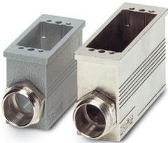
Carcasa de acoplamiento, metálica, con recubrimiento CEM, construcción 4, número de módulos 5, prensaestopas Pg21
