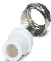
Prensaestopas partido Pg16, metálico, compuesto por una goma obturadora con un taladro y un tornillo de apriete, para carcasas de la construcción 1, cable [mm] 11,5 - 15,5
