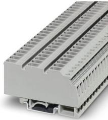
Borne de paso, tensión nominal: 800 V, corriente nominal: 20 A, número de conexiones: 4, número de polos: 1, tipo de conexión: Conexión por tornillo / conexión enchufable, sección: 0,2 mm<sup>2</sup> - 4 mm<sup>2</sup>, clase de montaje: NS 35/7,5, NS 35/15, NS 32, color: gris
