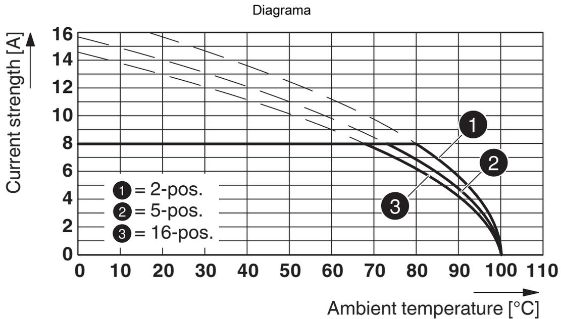
Tipo: MC 1,5/...-STF-3,81 con DFK-MC 1,5/...-GF-3,81 (con conector plano)
