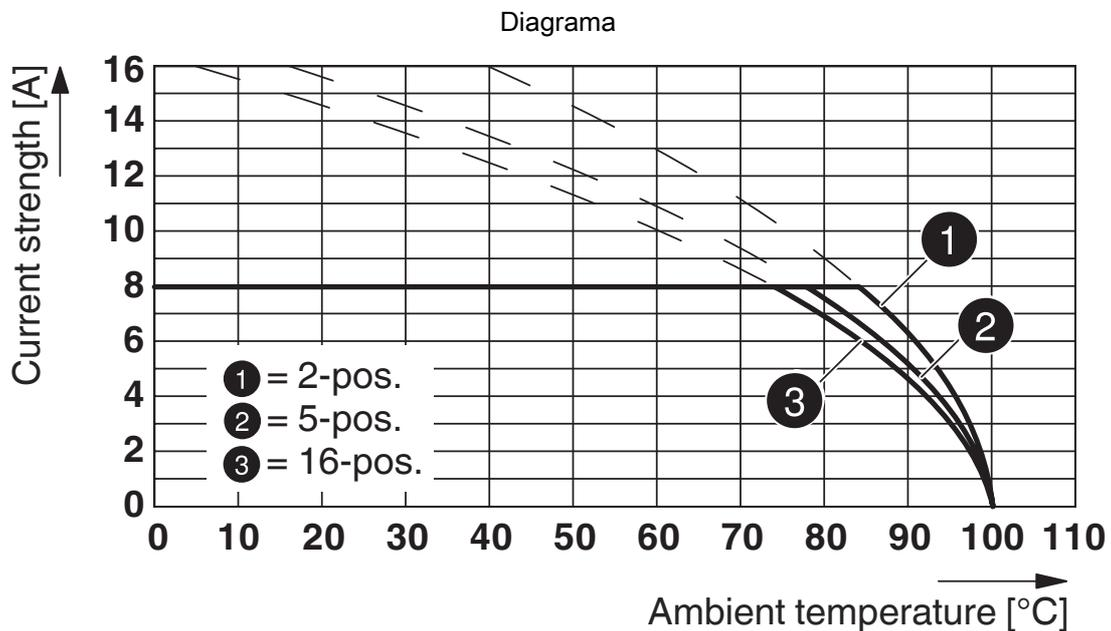
Tipo: MC 1,5/...-STF-3,81 con DFK-MC 1,5/...-GF-3,81 (con conexión por soldadura)
