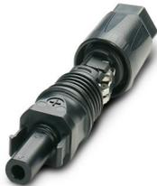
Conector, Familia de artículos: SUNCLIX, color: negro, número de polos: 1, sección mín. de conductor: 2,5 mm<sup>2</sup>, sección máx. de conductor: 6 mm<sup>2</sup>, tensión nominal: 1100 V DC, corriente asignada: 40 A, Tipo de conexión: Por resorte, diámetro de cable mín.: 5,5 mm, diámetro de cable máx.: 8 mm, El artículo siguiente es 1386381
