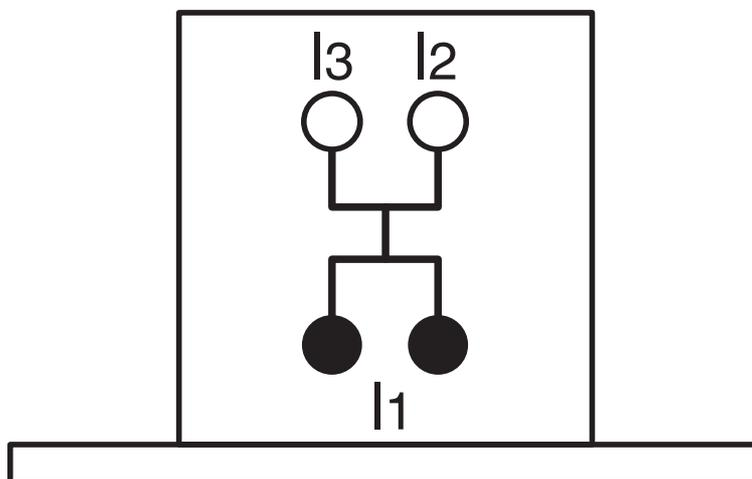
Esquema de taladros/geometría pads soldadura
