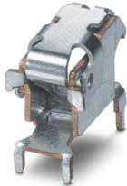
Terminal impreso para cables flexibles estañados, p. ej., del tipo PV 1-F, corriente nominal: 41 A, n.º polos: 1, técnica de conexión: conexión por resorte, montaje: THT/THR; encontrará más información para el usuario sobre la tecnología Through Hole Reflow en: [combicon.com](http://combicon.com)
