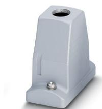
Carcasa aérea HEAVYCON ADVANCE EMV B10, con bloqueo por tornillo, altura 100 mm, con rosca 1x M25, salida de cables recta
