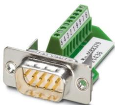
Inserto de contactos D-SUB, tamaño de envoltura 1, con 9 contactos de señal, tipo de conexión del contacto: macho, conexión por tornillo, recto, para marcos empotrados y carcasas aéreas en índice de protección IP67
