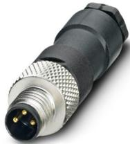
Conector, Universal, 3-polos, Conector macho recto M8, codificación: A, Conexión por soldadura, material de moleteado: Latón, niquelado, diámetro exterior del cable 3,5 mm ... 5 mm
