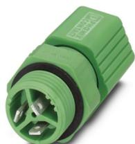
Pasamuros QUICKON, para montaje en pared exterior con conexión por soldadura manual/conexión de enchufe plano, 2,8 mm x 0,8 mm, 3 polos.
