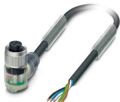
Cable para sensores/actuadores, 5-polos, PUR sin halógenos, negro grisáceo RAL 7021, extremo de cable libre, a Hembra acodado M12, codificación: A, con 3 LEDs, longitud de cable: 5 m
