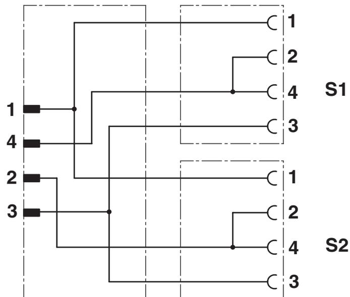
Ocupación de contactos del conector macho M12 y del conector hembra M12
