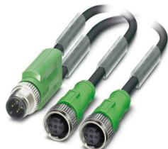
Cable para sensores/actuadores, 3-polos, PUR sin halógenos, negro grisáceo RAL 7021, Conector recta M12, codificación: A, a Hembra recta M12, codificación: A, PIN 2+4 puenteado y Hembra recta M12, codificación: A, PIN 2+4 puenteado, longitud de cable: 0,3 m
