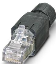
Conector enchufable RJ45, diseño: RJ45, índice de protección: IP20, número de polos: 8, 1 GBit/s, CAT5, material: Plástico, tipo de conexión: Conexión por desplaz. de aislamiento, sección de conexión: AWG 26- 23, salida de cables: recta, color: negro, Ethernet
