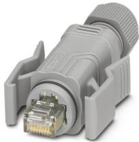
Conector enchufable RJ45, diseño: RJ45, índice de protección: IP67, número de polos: 8, 1 GBit/s, CAT5, material: Plástico, tipo de conexión: Conexión rápida IDC, sección de conexión: AWG 26- 23, salida de cables: recta, color: gris tráfico A RAL 7042, Ethernet
