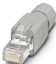
Conector enchufable RJ45, diseño: RJ45, índice de protección: IP20, número de polos: 8, 1 GBit/s, CAT5, material: Plástico, tipo de conexión: Conexión por desplaz. de aislamiento, sección de conexión: AWG 26- 23, salida de cables: recta, color: gris tráfico A RAL 7042, Ethernet
