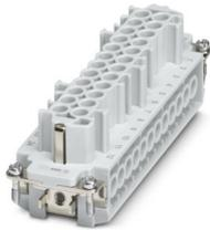
Inserto de contactos, número de polos: 24+PE, tamaño: B24, número de conexiones por polo: 1, Hembra, Conexión por tornillo, 500 V, 16 A, 0,5 mm<sup>2</sup> ... 2,5 mm<sup>2</sup>, aplicación: Potencia
