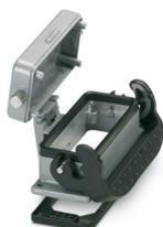
Carcasa empotrada B16, con brida longitudinal, material: Fundición de aluminio a presión, material tapa protectora: Al, altura: 29 mm, prensaestopas: sin, tapa de protección: sí, Estándar, con junta plana
