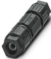
Econnecteur de câble, tipo de conexión: Conexión IDC, 0,34 mm<sup>2</sup> ... 0,75 mm<sup>2</sup>, 250 V, 9 A, negro, codificación: no, diámetro exterior del cable: 4 mm ... 8 mm
