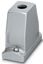
Carcasa aérea HEAVYCON ADVANCE STA, B10, con bloqueo por tornillo, altura 100 mm, con rosca 1x M25, con salida de cables recta, con tornillos hexagonales interiores M6 x 18 en acero inoxidable según DIN EN ISO 4762
