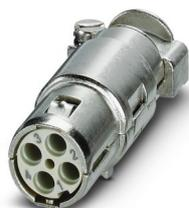
Conector enchufable CEM HEAVYCON, variante hembra de conexión, 4 polos, para la conexión de conductores apantallados con un diámetro exterior del cable de 3 ... 9,5 mm. Para el inserto en el módulo de plástico HC-M-02-EMC-F
