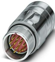
M23, Conector de acoplamiento, serie: CA, recto, apantallado: sí, para bloqueo estándar y SPEEDCON, N° de polos: 12, Sentido de giro: Estándar, tipo de conexión del contacto: Macho, Conexión crimpada, rango de diámetro de cable: 6 mm ... 10 mm, codificación: N, se espera que este artículo no contenga plomo a partir del primer trimestre de 2026 de acuerdo con RoHS II sin excepción 6c (Pb <0,1 %), una alternativa sin plomo está disponible previamente a petición
