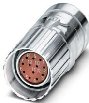
M23, Conector para cables, serie: CA, recto, apantallado: sí, Bloqueo por tornillo, N° de polos: 12, Sentido de giro: Estándar, tipo de conexión del contacto: Hembra, Conexión crimpada, rango de diámetro de cable: 3 mm ... 14,5 mm, codificación: N, se espera que este artículo no contenga plomo a partir del segundo trimestre de 2026 de acuerdo con RoHS II sin excepción 6c (Pb <0,1 %), una alternativa sin plomo está disponible previamente a petición
