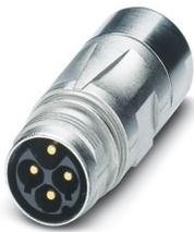
Conector de acoplamiento, recto, para bloqueo estándar y SPEEDCON, M17, número de polos: 3+PE, tipo de conexión del contacto: Macho, apantallado: sí, índice de protección: IP67, rango de diámetro de cable: 5 mm ... 9,2 mm, número de polos: 4, tipo de conexión: Conexión crimpada, serie: ST, se espera que este artículo no contenga plomo a partir del cuarto trimestre de 2026 de acuerdo con RoHS II sin excepción 6c (Pb <0,1 %), una alternativa sin plomo está disponible previamente a petición
