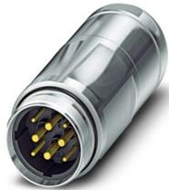
Conector de acoplamiento, recto, para bloqueo estándar y SPEEDCON, M40, número de polos: 2+3+PE, tipo de conexión del contacto: Macho, apantallado: sí, índice de protección: IP67, rango de diámetro de cable: 9 mm ... 14 mm, número de polos: 6, tipo de conexión: Conexión crimpada, serie: SM, se espera que este artículo no contenga plomo a partir del tercer trimestre de 2025 de acuerdo con RoHS II sin excepción 6c (Pb <0,1 %), una alternativa sin plomo está disponible previamente a petición
