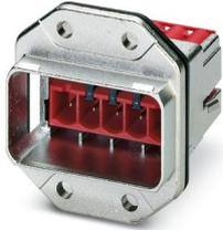
Marco empotrado MSTB, IP67, para bloqueo push-pull, metal, con inserto de contactos integrado para conexión de conductores, conexión por resorte, 400 V, para abertura de montaje rectangular, con junta, sin tornillos de fijación
