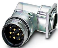
Conect. enchuf. para apar. pared delant., Acodado giratorio, para bloqueo estándar y SPEEDCON, M40, número de polos: 2+3+PE, tipo de conexión del contacto: Macho, Anillo tórico axial, apantallado: sí, medida de brida: 40 mm x 40 mm, número de polos: 6, tipo de conexión: Conexión crimpada, serie: SM
