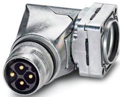
Conect. enchuf. para apar. pared delant., Acodado giratorio, SPEEDCON, M17, número de polos: 3+PE, tipo de conexión del contacto: Macho, Anillo tórico axial, apantallado: sí, medida de brida: 21,6 mm x 21,6 mm, número de polos: 4, tipo de conexión: Conexión crimpada, serie: ST
