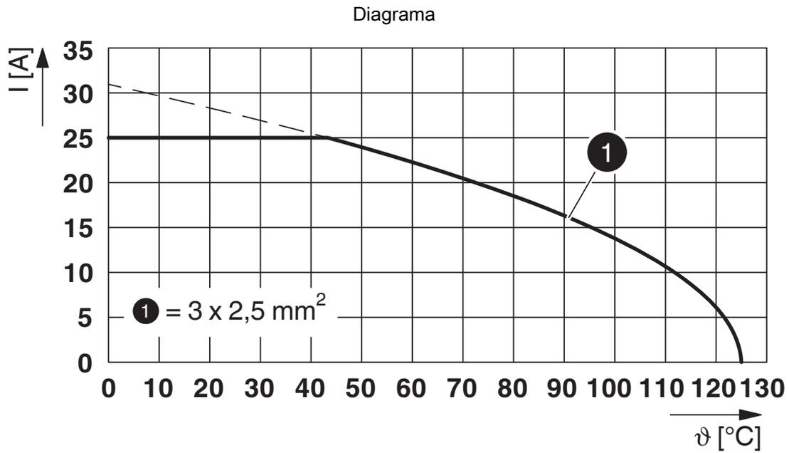
$I$  = intensidad de corriente,  $\vartheta$  = temperatura ambiente, 3x 25 A
