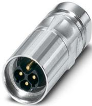
Conector para cables, recto, Bloqueo por tornillo, M17, número de polos: 3+PE, tipo de conexión del contacto: Macho, apantallado: sí, índice de protección: IP67, rango de diámetro de cable: 5 mm ... 8 mm, número de polos: 4, tipo de conexión: Conexión crimpada, serie: ST, se espera que este artículo no contenga plomo a partir del tercer trimestre de 2025 de acuerdo con RoHS II sin excepción 6c (Pb <0,1 %), una alternativa sin plomo está disponible previamente a petición
