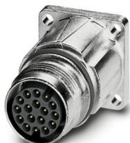
Conect. enchuf. para apar. pared delant., recto, para bloqueo estándar y SPEEDCON, M17, número de polos: 17, tipo de conexión del contacto: Macho, apantallado: sí, medida de brida: 21,6 mm x 21,6 mm, número de polos: 17, tipo de conexión: Conexión crimpada, serie: ST
