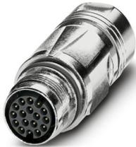
Conector de acoplamiento, recto, para bloqueo estándar y SPEEDCON, M17, número de polos: 17, tipo de conexión del contacto: Macho, apantallado: sí, índice de protección: IP67, rango de diámetro de cable: 5 mm ... 8 mm, número de polos: 17, tipo de conexión: Conexión crimpada, serie: ST, se espera que este artículo no contenga plomo a partir del cuarto trimestre de 2025 de acuerdo con RoHS II sin excepción 6c (Pb <0,1 %), una alternativa sin plomo está disponible previamente a petición
