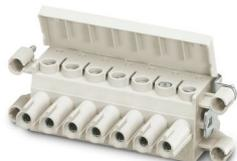
Inserto de contactos, Familia de artículos: VARIOCON, diseño: VC4, color: gris claro, número de polos: 7, sección mín. de conductor: 0,5 mm<sup>2</sup>, sección máx. de conductor: 16 mm<sup>2</sup>, corriente asignada: 70 A, Tipo de conexión: Conexión por tornillo, Los conectores enchufables deben accionarse solo en estado inerte (sin carga).
