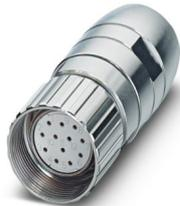
M23, Conector para cables, serie: UC, recto, apantallado: sí, Bloqueo por tornillo, N° de polos: 16, Sentido de giro: Estándar, tipo de conexión del contacto: Hembra, Copa de soldar, rango de diámetro de cable: 2 mm ... 14,5 mm, codificación: N, se espera que este artículo no contenga plomo a partir del segundo trimestre de 2026 de acuerdo con RoHS II sin excepción 6c (Pb <0,1 %), una alternativa sin plomo está disponible previamente a petición
